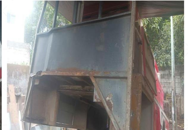
▪ **IMAGEN 3.-** La lata posterior de la cabina en el asiento del conductor, tambien estaba afectada por el oxido y la misma podia causar cualquier tipo de incidente al momento de atender una emergencia.
